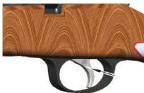
Fig. 1: Seguro de gatillo activado
